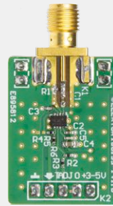
Figuur 4. De (vierlaags!) print van de RF-module.
